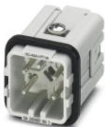
Inserto contatti, numero poli: 4+PE, dimensioni: D7, numero di connessioni per polo: 1, Maschio, Connessione Push-in, 230 V/400 V, 16 A, 0,14 mm<sup>2</sup> ... 1,5 mm<sup>2</sup>
