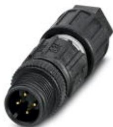
Connettore sensore-attuatore, Universale, 4-poli, Maschio diritto M12, codifica A, Connessione a perforazione di isolante, materiale zigrinato: Plastica, diametro esterno cavo 3,5 mm ... 6 mm
