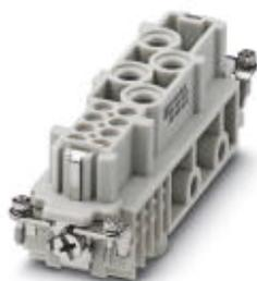
Inserto portacontatti femmina HEAVYCON, serie K4/8, per 4 contatti di potenza e 8 contatti di comando, connessione a vite senza protezione per fili
