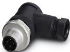
Connettori, Universale, Universale, 4-poli, Maschio angolato M12, codifica A, Connessione a vite, materiale zigrinato: Pressogetto di zinco, nichelato, connessione a vite per cavo Pg7, diametro esterno cavo 4 mm ... 6 mm
