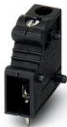
Morsetto per circuiti stampati, corrente nominale: 24 A, tensione di dimensionamento (III/2): 630 V, sezione nominale: 2,5 mm<sup>2</sup>, passo: 7,5 mm, numero poli: 1, collegamento: Connessione a vite con gabbia, montaggio: Saldatura ad onde, direzione di collegamento conduttore/scheda: 0 °, colore: verde, Layout Pin: Piedinatura doppia lineare, Lunghezza pin [P]: 5 mm. L'articolo può essere allineato con diversi numeri di poli!
