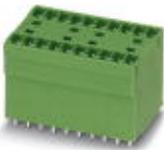
Presse base per circuiti stampati, corrente nominale: 8 A, tensione di dimensionamento (III/2): 160 V, sezione nominale: 1,5 mm<sup>2</sup>, numero poli: 2, passo: 3,81 mm, colore: verde, superficie contatti: Stagno, montaggio: Saldatura ad onde, layout pin: Pinning lineare, lunghezza pin [P]: 3,4 mm, Nel caso della combinazione con i connettori MCV, utilizzare un connettore maschio MCVW e un connettore maschio MCVR.
