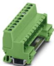
Connettore della guida, corrente nominale: 12 A, tensione di dimensionamento (III/2): 320 V, sezione nominale: 2,5 mm<sup>2</sup>, numero poli: 10, passo: 5 mm, collegamento: Connessione a vite con gabbia, colore: verde, superficie contatti: Stagno, montaggio: Guida di supporto
