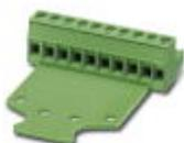
Connettore per circuiti stampati, corrente nominale: 12 A, tensione di dimensionamento (III/2): 320 V, sezione nominale: 2,5 mm<sup>2</sup>, numero poli: 10, passo: 5 mm, collegamento: Connessione a vite con gabbia, colore: verde, superficie contatti: Stagno
