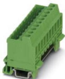
Connettore della guida, corrente nominale: 12 A, tensione di dimensionamento (III/2): 320 V, sezione nominale: 2,5 mm<sup>2</sup>, numero poli: 2, passo: 5,08 mm, collegamento: Connessione a vite con gabbia, colore: verde, superficie contatti: Stagno, montaggio: Guida di supporto
