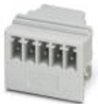
Presse base per circuiti stampati, numero poli: 5, passo: 3,5 mm, colore: grigio chiaro, superficie contatti: Stagno, layout pin: Pinning lineare, lunghezza pin [P]: 2 mm, Articolo con uscita pin laterale
