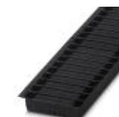
Presse base per circuiti stampati, numero poli: 5, passo: 3,5 mm, colore: nero, superficie contatti: Stagno, layout pin: Pinning lineare, lunghezza pin [P]: 3,4 mm, Le informazioni per l'utente e le proposte di progettazione per la tecnologia Through Hole Reflow sono indicate nella pagina ["Download"](#)
