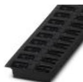
Presse base per circuiti stampati, numero poli: 5, passo: 3,5 mm, colore: nero, superficie contatti: Stagno, layout pin: Pinning lineare, lunghezza pin [P]: 2,6 mm, Le informazioni per l'utente e le proposte di progettazione per la tecnologia Through Hole Reflow sono indicate nella pagina "Download"
