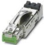
Connettore RJ45, grado di protezione: IP20, numero poli: 8, 1 Gbit/s, CAT5 (IEC 11801:2002), materiale: Pressofuso di zinco, collegamento: Connessione rapida IDC, sezione di connessione: AWG 26- 24, uscita cavo: diritto, colore: verde
