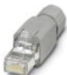
Connettore RJ45, grado di protezione: IP20, numero poli: 4, 100 MBit/s, CAT5 (IEC 11801:2002), materiale: PA, collegamento: Connessione rapida IDC, uscita cavo: diritto, colore: grigio traffico A RAL 7042
