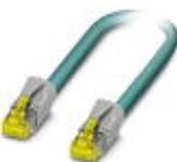
Cavo patch, CAT6<sub>A</sub>, 4 coppie, schermato, collegamento non incrociato (Line), confezionato su entrambi i lati con connettori RJ45/IP20, materiale guaina esterna: PUR, lunghezza: 3,0 m
