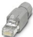
Connettore RJ45, grado di protezione: IP20, numero poli: 8, 1 Gbit/s, CAT5 (IEC 11801:2002), materiale: PA, collegamento: Connessione rapida IDC, sezione di connessione: AWG 26- 23, uscita cavo: diritto, colore: grigio traffico A RAL 7042
