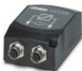
Isolatore di rete passivo per separazione galvanica nelle reti Ethernet. Per la protezione di dispositivi Ethernet da differenze di potenziale fino a 4 kV. Utilizzabile per velocità di trasmissione fino a 100 MBit/s. Connessione Ethernet mediante due connettori femmina M12 (codifica D).
