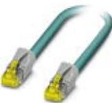
Cavo patch, CAT6<sub>A</sub>, 4 coppie, schermato, collegamento non incrociato (Line), confezionato su entrambi i lati con connettori RJ45/IP20, materiale guaina esterna: PUR, lunghezza: 2,0 m
