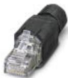
Connettore RJ45, grado di protezione: IP20, numero poli: 8, 1 Gbit/s, CAT5 (IEC 11801:2002), materiale: PA, collegamento: Connessione rapida IDC, sezione di connessione: AWG 26- 23, uscita cavo: diritto, colore: nero
