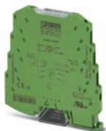
Isolatore galvanico MCR a 3 vie, per la separazione galvanica di segnali analogici, connessione a vite, ingresso: 4 mA ... 20 mA, uscita: 0 V ... 10 V
