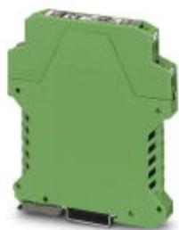
Amplificatore di isolamento a 3 vie MCR per la separazione galvanica di segnali analogici, segnale di ingresso: 0 ... 10 V / (+/-) 10 V, segnale di uscita: 0 ... 10 V / (+/-)10 V. Articolo di ricambio: 2902042 MINI MCR-2-U-U.
