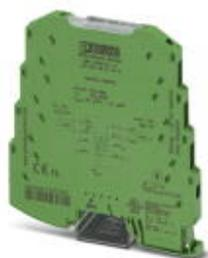
Isolatore galvanico MCR a 3 vie, per la separazione galvanica di segnali analogici, connessione a vite, ingresso: 0(4) mA ... 20 mA, uscita: 0(4) mA ... 20 mA
