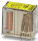
Relè di sicurezza con contatti a carica positiva secondo DIN EN 61810-3, esecuzione contatti a 2 contatti di scambio. I requisiti per tipo A secondo DIN EN 61810-3 vengono soddisfatti quando il collegamento è eseguito come 1 contatto aperto a riposo / 1 contatto in apertura.
