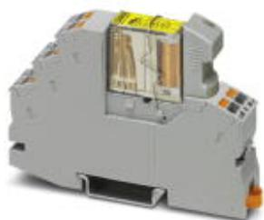
Modulo relè premontato con connessione Push-in, costituito da: base per relè, relè di sicurezza con contatti a carica positiva secondo DIN EN 61810-3, modulo a inserto di visualizzazione/soppressione dei disturbi e leva di fissaggio, esecuzione contatti: 2 contatti di scambio, tensione di ingresso: 24 V DC
