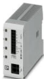
Interruttore di protezione elettronico a più canali con interfaccia IO-Link per la protezione di quattro utenze da 24 V DC in caso di sovraccarico e corto circuito. Con blocco elettronico delle correnti nominali impostate. Per installazione su guide DIN.
