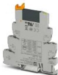
PLC-INTERFACE, composta da morsetto base PLC-BSC.../21 con connessione a vite e relè a stato solido in miniatura a innesto, per montaggio su guida di montaggio NS 35/7,5, 1 contatto aperto a riposo ingresso: 24 V DC, uscita: 3-33 V DC/3 A
