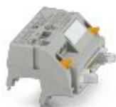
Adattatore V8 per 8 x PLC-INTERFACE (6,2 mm), controllore: Cablaggio di sistema PLC delle schede di uscita, collegamento 1: Connessione a vite 1x, collegamento 2: Connettore maschio IDC/FLK 1x 14-poli, collegamento 3: Attacco connettore (Può essere agganciato a scatto su 8 morsetti PLC-INTERFACE), numero di canali: 8, logica di comando: commutazione positiva
