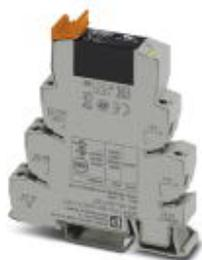
PLC-INTERFACE per funzioni di output, composta da morsetto base PLC-BSC.../ACT con connessione a vite e relè a stato solido in miniatura a innesto, per il montaggio su guida di montaggio NS 35/7,5, 1 contatto aperto a riposo, ingresso: 24 V DC, uscita: 3 ... 33 V DC/5 A
