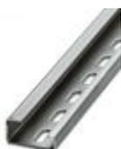
Guida di supporto forata, Profilo G, larghezza: 32 mm, altezza: 15 mm, a norma EN 60715, materiale: Acciaio, zincato, passivato a strato spesso, lunghezza: 2000 mm, colore: argento
