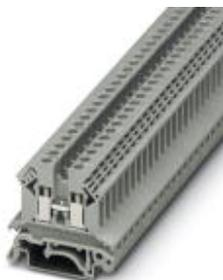
Morsetto passante, tensione nominale: 690 V, corrente nominale: 24 A, collegamento: Connessione a vite, numero di connessioni: 2, sezione: 0,2 mm<sup>2</sup> - 4 mm<sup>2</sup>, AWG: 24 - 12, larghezza: 6,2 mm, colore: grigio, tipo di montaggio: NS 35/7,5, NS 35/15
