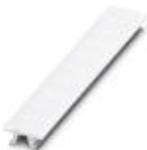
Segnamorsetti, Striscia, bianco, siglato, siglabile con: CMS-P1-PLOTTER, siglatura longitudinale: U, V, W, N, GND, U, V, W, N, GND, tipo di montaggio: inserimento a scatto in scanalatura alta portacartellini, per morsetti con spessore: 6,2 mm, dimensioni campo di siglatura: 6,15 x 10,5 mm, Numero dei cartellini singoli: 10
