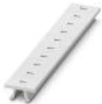
Nastro Zack, Striscia, bianco, siglato, siglabile con: CMS-P1-PLOTTER, siglatura longitudinale: cifre identiche 1 oppure 2 ecc. fino a 100, tipo di montaggio: inserimento a scatto in scanalatura alta portacartellini, per morsetti con spessore: 6,2 mm, dimensioni campo di siglatura: 6,15 x 10,5 mm, Numero dei cartellini singoli: 10
