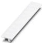
Segnamorsetti, Striscia, bianco, siglato, siglabile con: CMS-P1-PLOTTER, longitudinale: L1, L2, L3, N, PE, L1, L2, L3, N, PE, tipo di montaggio: inserimento a scatto in scanalatura alta portacartellini, per morsetti con spessore: 6,2 mm, dimensioni campo di siglatura: 6,15 x 10,5 mm, Numero dei cartellini singoli: 10
