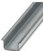
Guida di supporto, non perforata, Profilo standard, larghezza: 35 mm, altezza: 15 mm, simile a norma EN 60715, materiale: Acciaio, zincato, lunghezza: 2000 mm, colore: color argento
