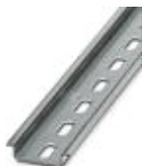
Guida di supporto forata, Profilo standard, larghezza: 35 mm, altezza: 7,5 mm, a norma EN 60715, materiale: Acciaio, zincato, lunghezza: 2000 mm, colore: color argento
