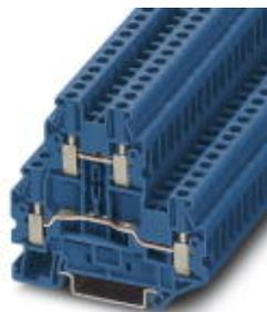
Morsetto a due piani, collegamento: Connessione a vite, sezione: 0,14 mm<sup>2</sup> - 4 mm<sup>2</sup>, AWG: 26 - 12, larghezza: 5,2 mm, colore: blu, tipo di montaggio: NS 35/7,5, NS 35/15
