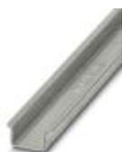
Guida di supporto, non perforata, Profilo standard 2,3 mm, larghezza: 35 mm, altezza: 15 mm, a norma EN 60715, materiale: Acciaio, zincato, passivato a strato spesso, lunghezza: 2000 mm, colore: color argento
