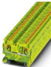
Morsetti comp. per conduttori terra, collegamento: Connessione Push-in, numero di connessioni: 2, sezione: 0,14 mm<sup>2</sup> - 4 mm<sup>2</sup>, AWG: 26 - 12, larghezza: 5,2 mm, altezza: 35,3 mm, colore: giallo-verde, tipo di montaggio: NS 35/7,5, NS 35/15
