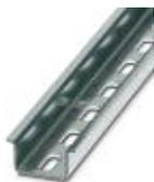
Guida di supporto forata, Profilo standard, larghezza: 35 mm, altezza: 15 mm, simile a norma EN 60715, materiale: Acciaio, zincato, passivato bianco, lunghezza: 2000 mm, colore: color argento
