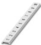
Nastro Zack piatto, Striscia, bianco, siglato, siglatura longitudinale: numeri progressivi 1 ...10, 11 ...20 ecc. fino a 91 ...100, tipo di montaggio: inserimento a scatto in scanalatura piatta portacartellini, per morsetti con spessore: 6,2 mm, dimensioni campo di siglatura: 5,15 x 6,15 mm, Numero dei cartellini singoli: 10
