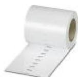
Segnamorsetti, Rotolo, bianco, in bianco, siglabile con: THERMOMARK ROLL 2.0, THERMOMARK ROLL, THERMOMARK ROLL X1, THERMOMARK ROLLMASTER 300/600, THERMOMARK X1.2, THERMOMARK S1.1, perforato, tipo di montaggio: fissaggio nella scanalatura portacartellini universale, inserimento a scatto in scanalatura piatta portacartellini, per morsetti con spessore: 6,2 mm, dimensioni campo di siglatura: 6,35 x 6,15 mm, Numero dei cartellini singoli: 16000
