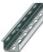
Guida di supporto forata, Profilo standard, larghezza: 35 mm, altezza: 15 mm, simile a norma EN 60715, materiale: Acciaio, zincato, passivato bianco, lunghezza: 2000 mm, colore: color argento
