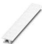
Segnamorsetti, Striscia, bianco, siglato, siglabile con: CMS-P1-PLOTTER, longitudinale: L1, L2, L3, N, PE, L1, L2, L3, N, PE, tipo di montaggio: inserimento a scatto in scanalatura alta portacartellini, per morsetti con spessore: 6,2 mm, dimensioni campo di siglatura: 6,15 x 10,5 mm, Numero dei cartellini singoli: 10
