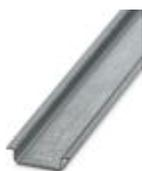
Guida di supporto, non perforata, Profilo standard, larghezza: 35 mm, altezza: 7,5 mm, a norma EN 60715, materiale: Acciaio, zincata, lunghezza: 2000 mm, colore: color argento
