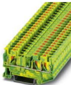
Morsetti comp. per conduttori terra, collegamento: Connessione Push-in, numero di connessioni: 3, sezione: 0,2 mm<sup>2</sup> - 6 mm<sup>2</sup>, AWG: 24 - 10, larghezza: 6,2 mm, colore: giallo-verde, tipo di montaggio: NS 35/7,5, NS 35/15
