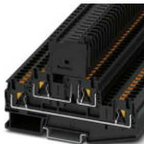
Morsetti portafusibili componibili, tipo di fusibile: Vetro / ceramica / ..., collegamento: Connessione Push-in, sezione: 0,2 mm<sup>2</sup>- 6 mm<sup>2</sup>, AWG: 24 - 10, corrente nominale: 28 A, tensione nominale: 500 V, larghezza: 6,2 mm, tipo fusibile: G / 5 x 20, tipo di montaggio: NS 35/7,5, NS 35/15, colore: nero
