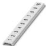
Nastro Zack piatto, Striscia, bianco, siglato, siglatura longitudinale: numeri progressivi 1 ...10, 11 ...20 ecc. fino a 491 ...500, tipo di montaggio: inserimento a scatto in scanalatura piatta portacartellini, per morsetti con spessore: 5 mm, dimensioni campo di siglatura: 5,15 x 5,15 mm, Numero dei cartellini singoli: 10
