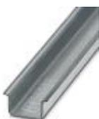
Guida di supporto, non perforata, Profilo standard, larghezza: 35 mm, altezza: 15 mm, simile a norma EN 60715, materiale: Acciaio, zincata, lunghezza: 2000 mm, colore: color argento
