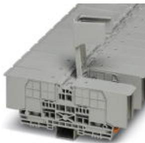
Morsetto di collegamento a bullone, tensione nominale: 1500 V, corrente nominale: 192 A, collegamento: Bullone, numero di connessioni: 2, numero poli: 1, larghezza: 29 mm, altezza: 66 mm, colore: grigio, tipo di montaggio: NS 35/7,5, NS 35/15, avvitamento diretto
