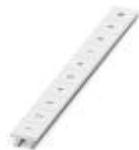
Nastro Zack, Striscia, bianco, siglato, siglabile con: CMS-P1-PLOTTER, siglatura longitudinale: numeri progressivi 1 ...10, 11 ...20 ecc. fino a 91 ...100, tipo di montaggio: inserimento a scatto in scanalatura alta portacartellini, per morsetti con spessore: 10,2 mm, dimensioni campo di siglatura: 10,15 x 10,5 mm, Numero dei cartellini singoli: 10
