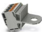
Morsetto di derivazione, tensione nominale: 1000 V, corrente nominale: 41 A, collegamento: Connessione Push-in, Bullone, numero di connessioni: 5, sezione: 0,5 mm<sup>2</sup> - 10 mm<sup>2</sup>, AWG: 20 - 8, larghezza: 31 mm, altezza: 32,3 mm, colore: grigio, tipo di montaggio: sull'elemento base
