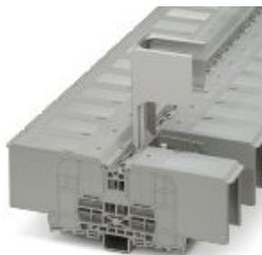
Morsetto di collegamento a bullone, tensione nominale: 1500 V, corrente nominale: 309 A, collegamento: Bullone, numero di connessioni: 2, numero poli: 1, larghezza: 41 mm, colore: grigio, tipo di montaggio: NS 35/7,5, NS 35/15, avvitamento diretto
