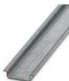
Guida di supporto, non perforata, Profilo standard, larghezza: 35 mm, altezza: 7,5 mm, a norma EN 60715, materiale: Acciaio, zincata, lunghezza: 2000 mm, colore: color argento
