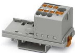
Blocco distributore, Blocco con orientamento verticale e alimentazione integrata, I blocchi sono ponticellabili tra di loro sopra il vano conduttori. Per ponticelli a innesto adatti, vedere accessori, tensione nominale: 690 V, corrente nominale: 24 A, collegamento: Connessione Push-in, Connessione Push-in, numero di connessioni: 7, sezione: 0,14 mm<sup>2</sup> - 4 mm<sup>2</sup>, AWG: 26 - 12, larghezza: 28,6 mm, colore: grigio, tipo di montaggio: NS 35/7,5, NS 35/15
