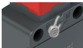
Gli interruttori con azionatore bloccato ad elettromagnete diseccitato (principio di funzionamento D) sono dotati di un dispositivo di sblocco ausiliario dell'elettromagnete, per facilitare l'installazione dell'interruttore e per accedere alla zona pericolosa in caso di mancanza
