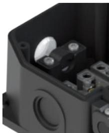
All'interno della custodia subito dopo l'ingresso cavi è presente un ferma cavo disposto in asse con il foro. Ideale per mantenere in posizione il cavo elettrico, evita che eventuali trazioni o movimenti ripetuti possano scaricarsi sulle connessioni elettriche delle unità di contatto. Reversibile, può serrare sia cavi di piccole che di grandi dimensioni.
