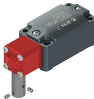
Durante l'installazione del dispositivo è possibile regolare il punto di intervento dei contatti su tutto l'arco dei 360°. Tramite il fissaggio del grano in dotazione si può verificare la corretta regolazione dell'angolo di attivazione e, se necessario, modificarlo in modo semplice e veloce. A regolazione ultimata con la spina di bloccaggio in dotazione si rende il dispositivo a prova di manomissione tramite attrezzi di uso comune.
