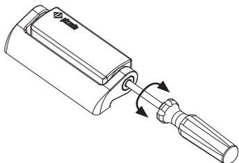
Il punto di intervento degli interruttori è regolabile mediante un semplice cacciavite. La regolazione del punto di scatto permette l'eventuale taratura per ripari di dimensioni notevoli. Dopo aver tarato l'interruttore è sempre necessario chiudere il foro mediante l'apposito tappo di sicurezza fornito in dotazione.
