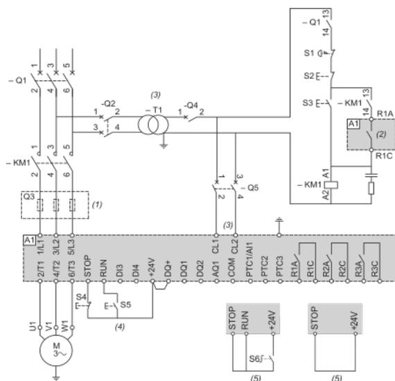
(1) : Installazione di fusibili ad azione rapida supplementari per l'aggiornamento al coordinamento di tipo 2 in base a IEC 60947-4-2.
