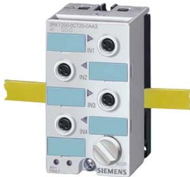
modulo compatto AS-i K45 digitale 4DI, IP67 4 x ingressi, max. 200 mA 4 x prese M8 esecuzione a vite piastra di montaggio 3RK1901-2EA00 o 3RK1901-2DA00 da ordinare separatamente
