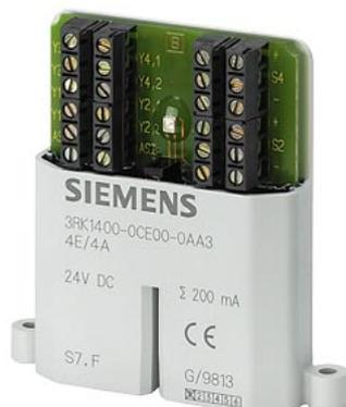
modulo piatto AS-i, digitale 4DI/4DQ, IP20 4 x ingressi per sensore a 3 fili 4 x uscite, DC 24 V alimentazione di uscita tramite U\_ASI morsetti a vite
