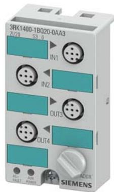
modulo compatto AS-i K45 digitale 2DI/2DQ, IP67 2 x ingressi, max. 200 mA 2 x uscite, 2 A DC 24 V max. 3 A per tutte le uscite 4 x prese M12 piastra di montaggio 3RK1901-2EA00 o 3RK1901-2DA00 da ordinare separatamente
