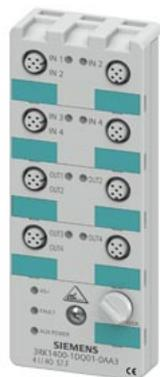
modulo compatto AS-i K60 digitale 4DI/4DQ, IP67 4 x ingressi, max. 200 mA 4 x uscite, 1 A, DC 24 V 8 x prese M12 con assegnazione Y-II piastra di montaggio 3RK1901-0CA00 da ordinare separatamente
