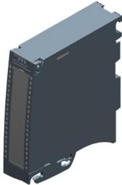
SIMATIC S7-1500, modulo di ingressi analogici, AI 8xU/I/R/RTD BA, risoluzione 16 bit, precisione 0,5 %, 8 canali in gruppi da 8, tensione di modo comune DC 4 V, diagnostica, interrupt di processo; fornitura compresa di un elemento di alimentazione, staffa per schermo e morsetto dello schermo: connettore frontale (morsetti a vite oppure push-in) da ordinare separatamente
