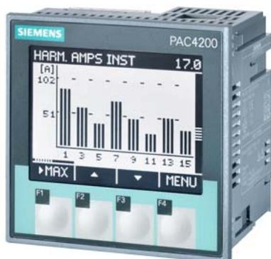
SETRON, dispositivo di misura, 7KM PAC4200, LCD, L-L: 690 V, L-N: 400 V, 5 A, trifase, Modbus TCP, Modbus RTU opzionale / PROFINET / PROFIBUS / DI/DO, energia apparente / attiva / reattiva / cos phi, armoniche: 2. - 64., THD, classe 0,2 secondo IEC61557-12 o classe 0,2S secondo IEC62053-22, alimentatore da rete wide-range, AC/DC, morsetti a vite
