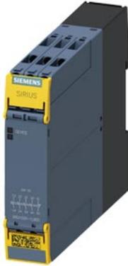
morsetto d'interfaccia a relè a guida forzata in custodia industriale 4 NO / 1 NC DC 24 V SIL 2 / PL c morsetti a vite
