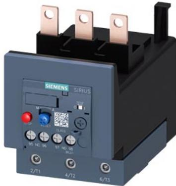
relè di sovraccarico 36...50 A termico per protezione motore grandezza costruttiva S3, CLASS 10 montaggio su contattore circuito principale: morsetti a vite circuito ausiliario: morsetti a vite reset manuale-automatico
