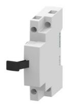
bobina di minima tensione AC 400 V, 50 Hz con blocchetto di contatti ausiliari anticipati 2 NO, per interruttori automatici 3RV1011
