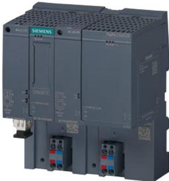
SIMATIC PN/PN Coupler per lo scambio di dati deterministico tra max. 4 PN-Controller per lato, anche tramite router, trasmissione di PROFI-safe, I/O, MSI, MSO e comunicazione con set di dati, alimentazione di corrente ridondante collegamento PN tramite BusAdapter SIMATIC (BA), Fornitura senza adattatore di bus
