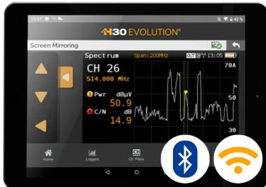
Equipaggiato di connettività WiFi 2,4/5GHz ed anche Bluetooth, lo strumento consente l'accesso sicuro mediante un dispositivo Android, iOS o PC (browser compatibile con HTML5). In questo modo, è possibile utilizzare a distanza l'applicazione di gestione WEB, tramite la quale si possono consultare e modificare i piani di canali, i profili di utente, si possono esportare le misure, ecc.
