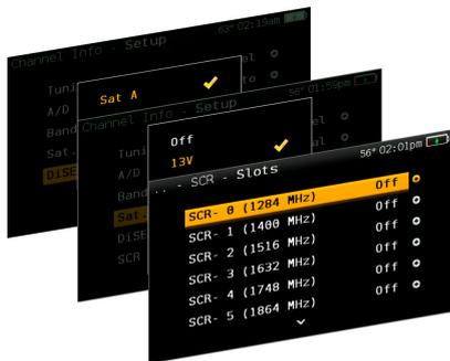
L'H30Evolution è configurato per impostare automaticamente i parametri necessari ed eggianciare il suo segnale satellitare. Inoltre con l'H30Evolution potremo alimentare amplificatori da palo, configurare parametri DiSEqC e SCR/dCSS.
