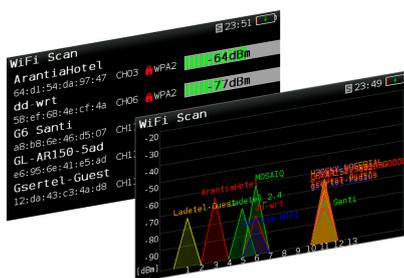
Con questa funzione è possibile realizzare l'analisi completa della banda WiFi per determinare automaticamente tutte le reti. Ognuna di esse è identificata con il proprio nome ed inoltre viene mostrato anche la potenza del segnale del punto di accesso.
