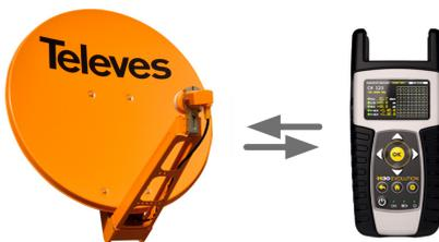
Questa funzione consente di facilitare il lavoro di orientamento della parabola. Il misuratore ottiene un satellite tipico e un transponder stabile in funzione dell'area geografica impostata, e si auto configura per la connessione con LNB. Inoltre, è possibile attivare un indicatore sonoro che guidi acusticamente l'utente nel puntamento della parabola. Il satellite di riferimento può essere variato manualmente, e iniziare un nuovo puntamento.
